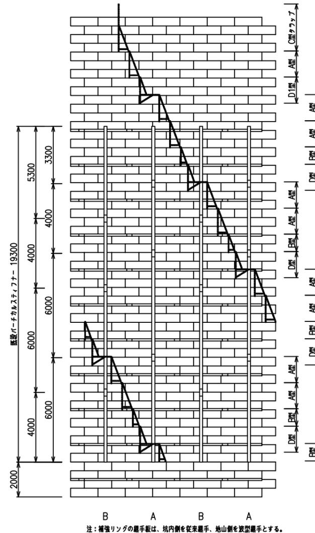
注：補強リングの継手板は、坑内側を従来継手、地山側を放型継手とする。
