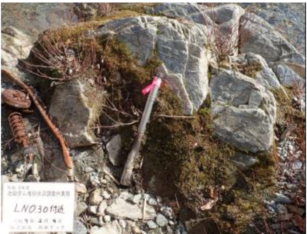
水位計設置例(陸上部)
