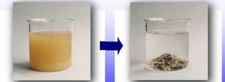
少量ですばやく凝集し、強靱で粗大なブロックを形成します。ブロックが大きくなる事で、汚泥の沈降速度が早くなります。
