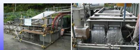
処理量 60m3/h~100m3/h (濁水貯蔵タンク) と (凝集処理タンク)
