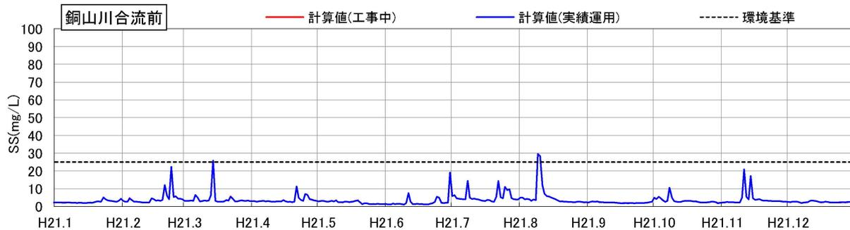
図 5-20(1) 土砂による水の濁り(SS) 予測結果
