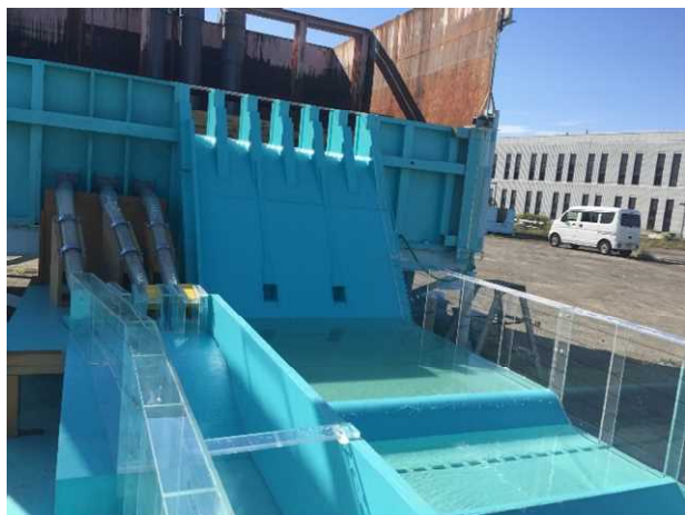
早明浦ダムの模型（縮尺1/62.5 高さ約1.7m）
