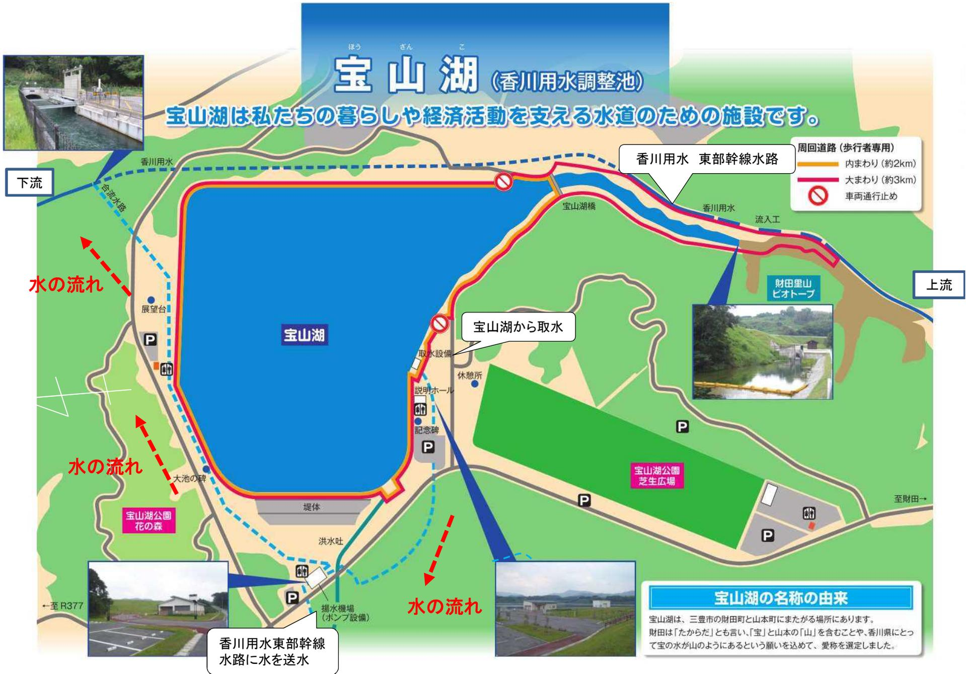
※図中の取水設備→揚水機場→香川用水東部幹線水路へ宝山湖の水を流します。
